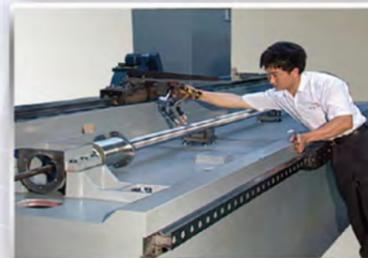
▼ 雷射精度量測補正
